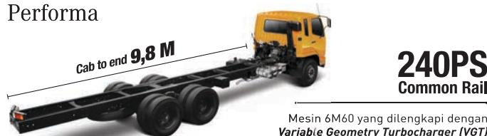
Mesin 6M60 yang dilengkapi dengan **Variable Geometry Turbocharger (VGT)** mampu menghasilkan torsi dan tenaga maksimal di putaran mesin yang rendah.
